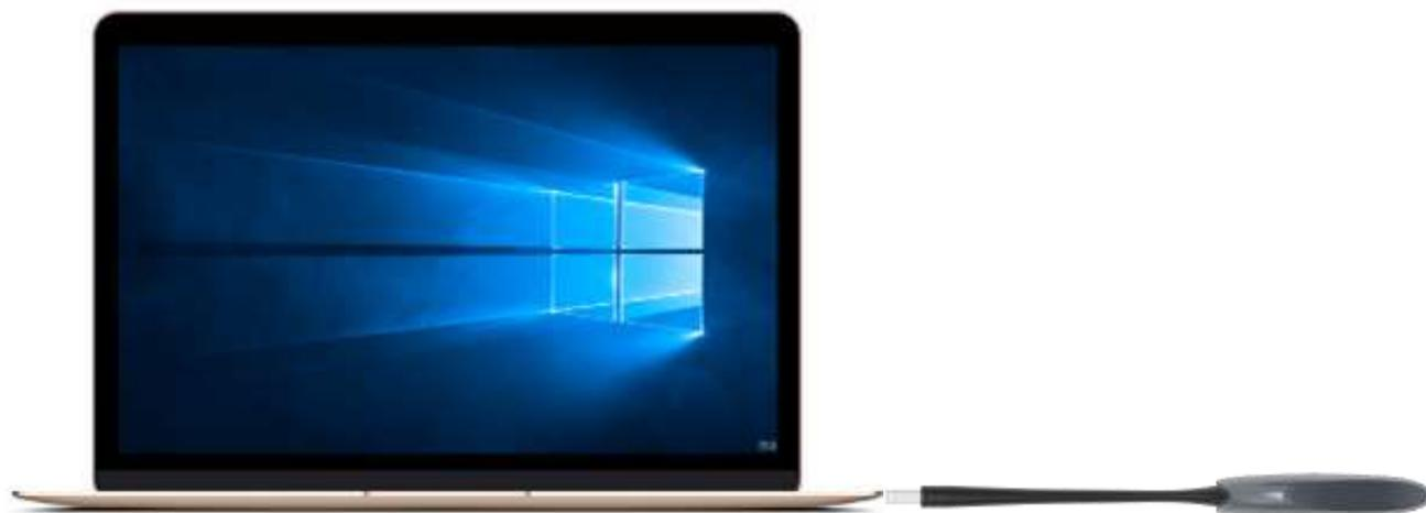
接続作業中はワイヤレスドングルが点滅し、パソコンの画面に「接続中」と表示されます。
