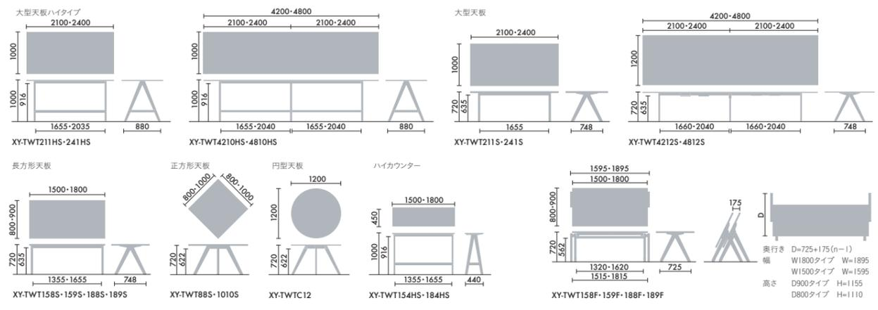
■天板…表面材:メラミン化粧板、エッジ:樹脂押出材 (ABS)、芯材:パーティクルボード ■脚…ブナ材、ウレタン塗装
