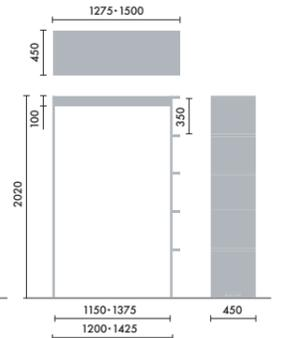
**シェルフ** ■天板・棚板…表面材:メラミン化粧板、エッジ:ABS ■支柱・ベース…表面材:メラミン化粧板 ■L型パネル…表面材:ビニルクロス ※アジャスター付(調整幅0~30mm)
