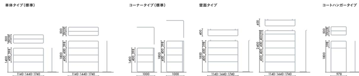
■スクリーン…本体:丸パイプ・粉体塗装(シボ)、アジャスター:PE・ABS ■コートハンガー…本体:丸パイプ・粉体塗装(シボ)、センターバー:丸パイプ・粉体塗装、アジャスター:PE・ABS ■プラントボックス…本体:ポリ合板、エッジ:ABS、アジャスター:PA ■ソファー連結タイプ…本体:ポリ合板、エッジ:ABS、アジャスター:PA、フレーム:丸パイプ・粉体塗装(シボ) ■ハイカウンター連結タイプ…本体:ポリ合板、エッジ:ABS、アジャスター:PA、フレーム:丸パイプ・粉体塗装(シボ)
