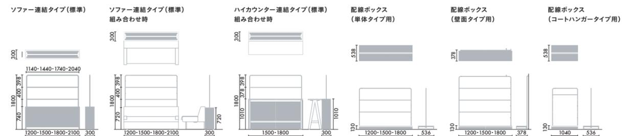
オプション ■配線ボックス…本体:メラミン化粧板、エッジ:ABS ■ホワイトボード…本体:不織布、フック:スチール・粉体塗装(シボ)、板面:スチール・塗装 ■ピンナップボード…本体:不織布、フック:スチール・粉体塗装(シボ) ■ブックスタンド…本体:不織布、フック:スチール・粉体塗装(シボ) ■ライトスタンド…本体:スチール・粉体塗装(シボ)、シェード:不織布 ■S字フック…スチール・粉体塗装(シボ) ■コーナータイプ用配線カバー…スチール、粉体塗装(シボ)
