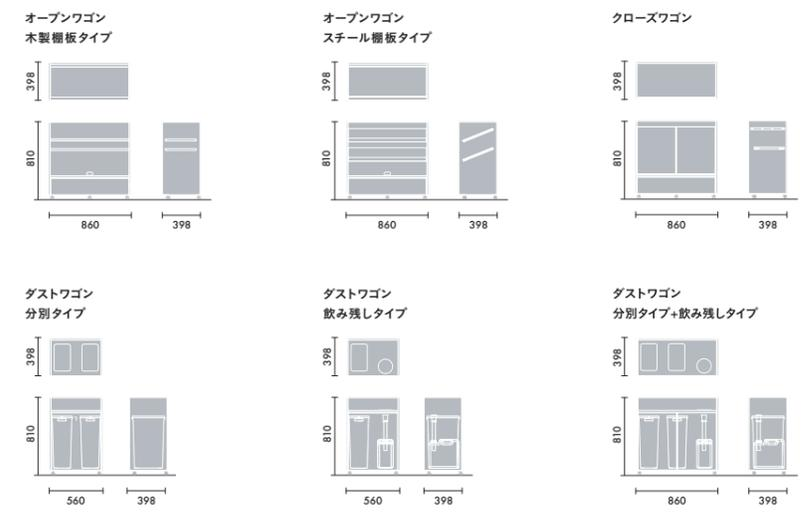
**ビッグカウンター** ■天板…表面材:メラミン化粧板、エッジ:突板ポリウレタン塗装着色仕上げ、芯材:LVL、合板 ■扉板…表面材:ポリ合板・プリントMDF、エッジ:ABS、芯材:LVL ■背パネル…表面材:プリント合板、エッジ:ABS、芯材:LVL ■エンドパネル…表面材:ポリ合板、エッジ:突板ポリウレタン塗装着色仕上げ(両側面)・メラミン化粧板(上下面) ■配線ビーム…スチール、粉体塗装(ホワイト、ブラック)
