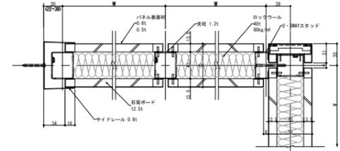
■パネル横断面詳細図(ロックワール充填)
