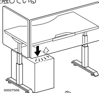
回転黒板の粉受けに天板が接触している
