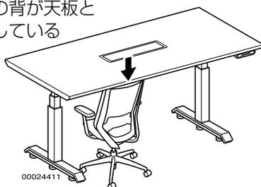
柔らかいものに天板が接触している（はさみ込み防止機能が正しく作動しない）
