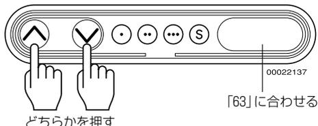
3. ⒶボタンまたはⒷボタンから指を離してから約5秒後に、表示画面の「63」が点滅し、天板高さ設定が再設定されます。
