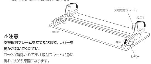
**3.**支柱取付フレームに脚支柱を取り付けてください。
