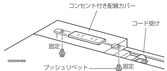
6.配線カバー (置き式) のストライクをコンセント付き配線カバーのカバー受けにはめ込むようにして取り付けてください。
