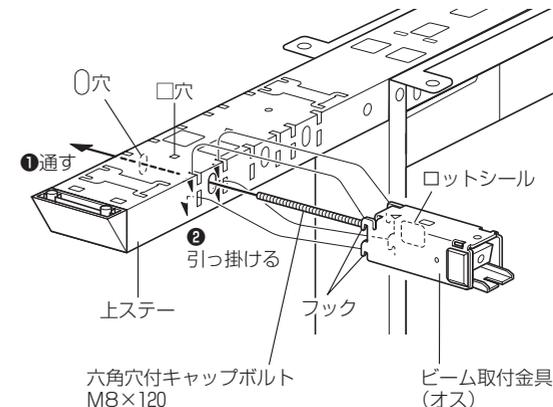
ボルトを差し込む位置 ※ロットシールが内側になるように取り付けてください。
