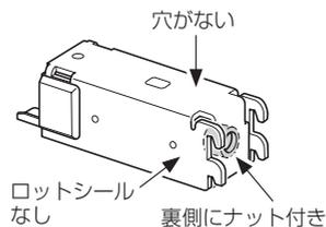
3.ビーム取付金具 (オス) に差し込んだボルトを上ステーに差し込み、ビーム取付金具 (オス) のフックを上ステーに引っ掛けてください。
