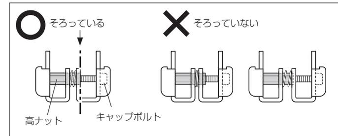
9. 天板引込金具をキャップボルトが付いている側を下に傾けて上ステーに入れてください。このとき、天板引込金具はキャップボルトが付いている側を上ステーの側面に○穴があいている面に向きを合わせてください。
