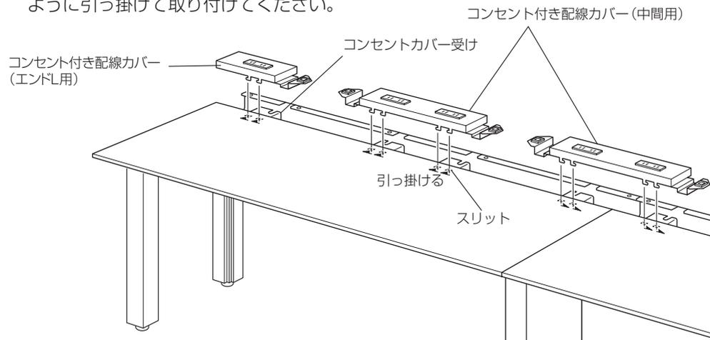
5.コード受けとコンセント付き配線カバーを、図のようにプッシュリベットで2カ所ずつ固定してください。
