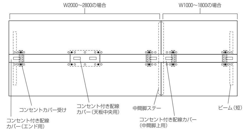
6.配線カバー（置き式）のストライクをコンセント付き配線カバーのカバー受けにはめ込むようにして、配線カバー（置き式）を取り付けてください。
