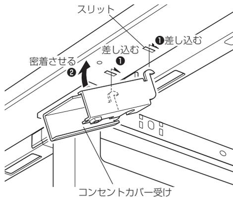
2.コンセントカバー受けを天板裏面に、ボルトで本締めしてください。
