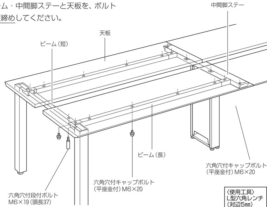
5.天板前面がそろるように調整しながら、中間脚ステーの横穴から天板引き込みボルトをねじ込んで、天板の高さを合わせて本締めしてください。
