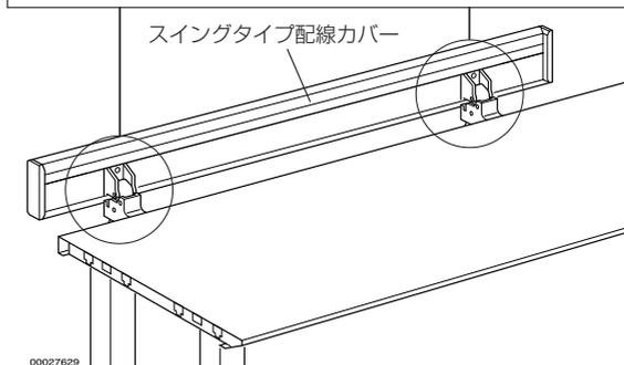
4.コード受けをスイングタイプ配線カバー受けに、ボルトで本締めしてください。
