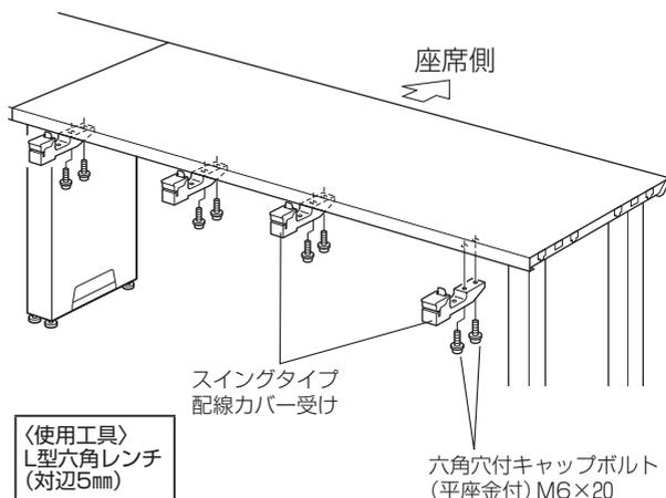
2.スイングタイプ配線カバーの凹み部にスイングタイプ配線カバー受けの凸部がはまるように取り付けてください。
