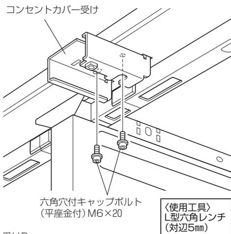
3.コンセントカバー受けにコード受けの吊り金具を図のように差し込み、吊り金具をコンセントカバー受けにボルトで本締めしてください。
